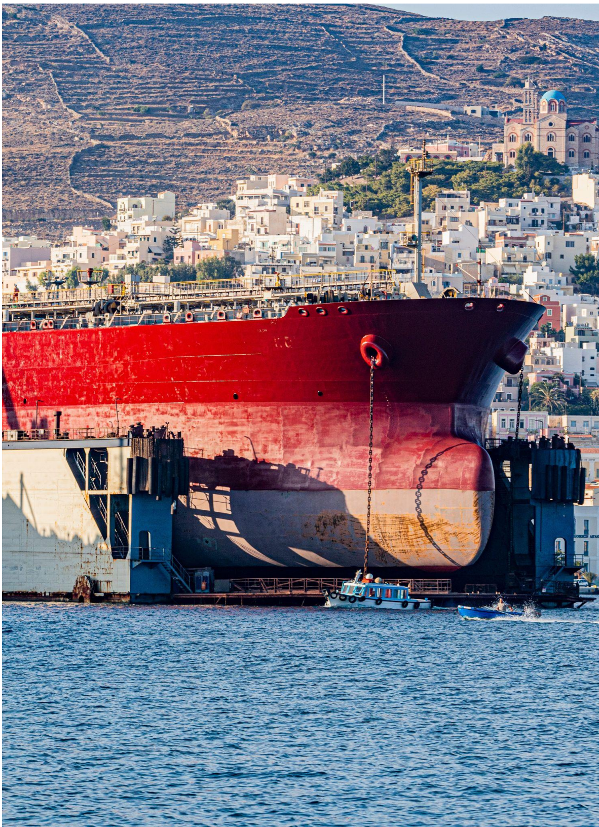
Πηγή φωτογραφίας Π.Π.Π.Σ. - Πλήρως εκτεθειμένες επιφάνειες στις καιρικές συνθήκες με αποτέλεσμα το overspray των βαφών και η σκόνη των αμμοβολών να διασπείρονται σε θάλασσα και αέρα
